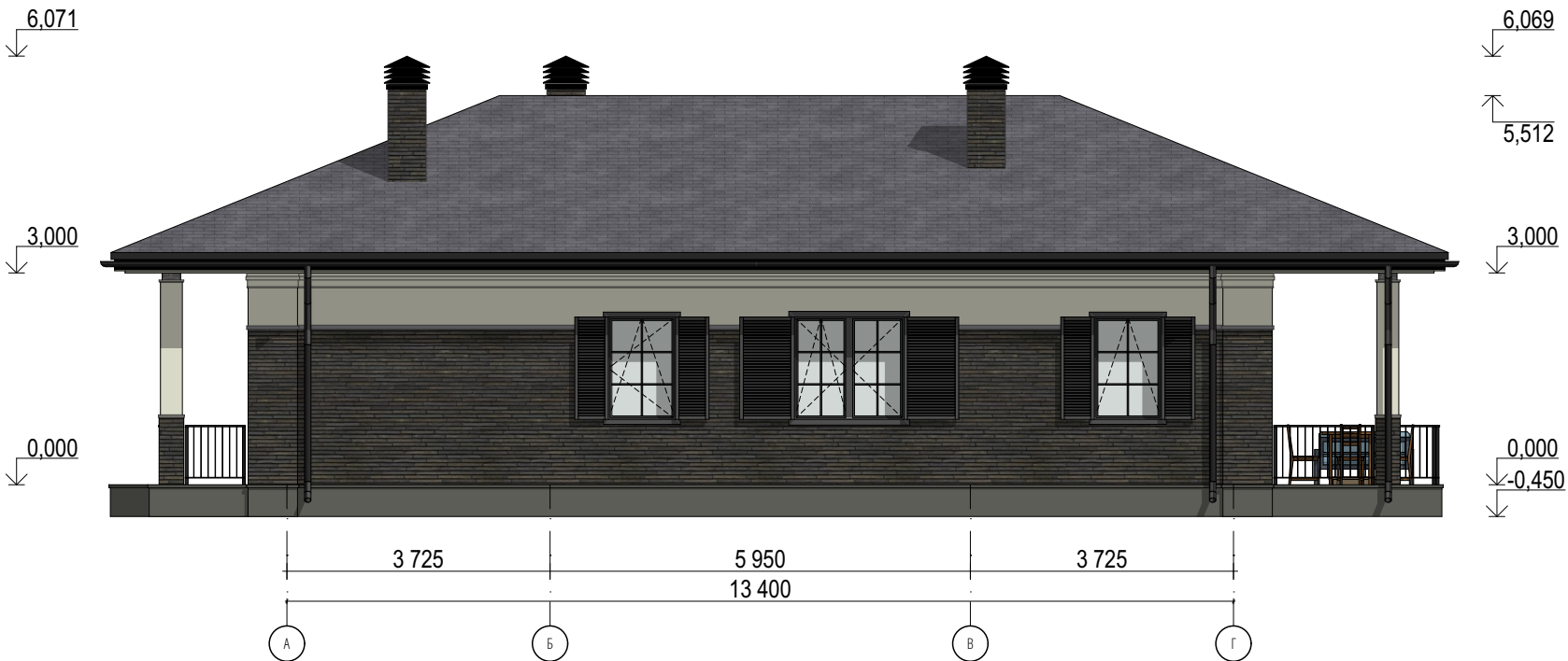
Фасад в осях А-Г
